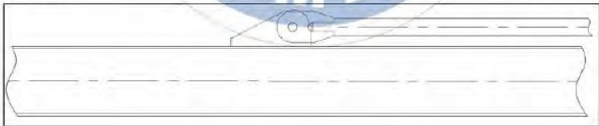
图5.5-5 安装平衡臂拉杆简图
